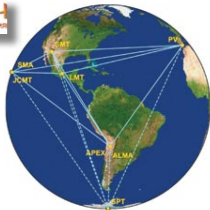
Event Horizon Telescope — система радиотелескопов — интерферометр со сверхдлинной базой (VLBI), измерения тактируются атомными часами
