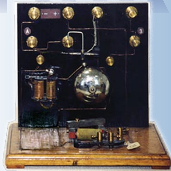
«Грозоотметчик» А.С. Попова. Изготовлен в Горьковском политехническом институте имени А.А. Жданова
