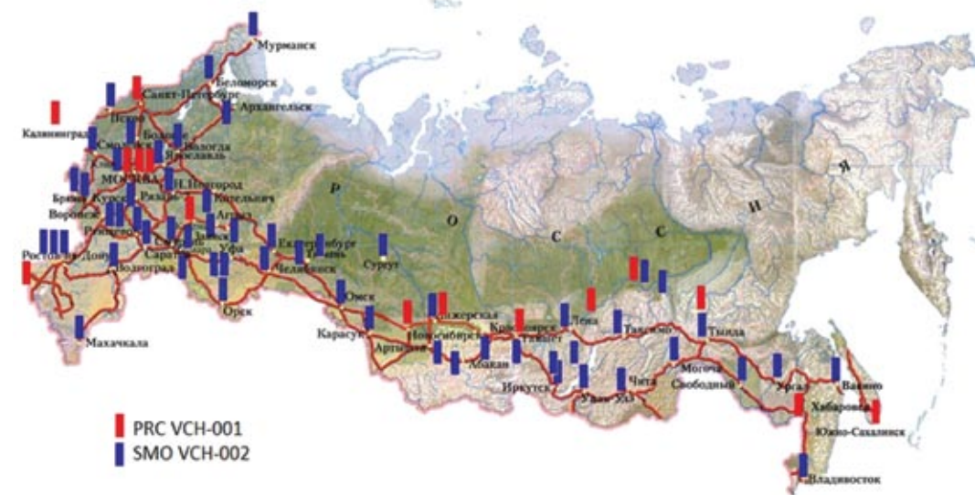
Системы синхронизации для цифровой связи. Более 100 вторичных задающих генераторов и более 15 первичных задающих генераторов установлены в телекоммуникационных сетях ТрансТелеком, СвязьТрансНефть, Ростелеком, РЖД и других
